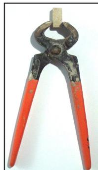
Am besten lassen sich die Steine der Steinpakete M-01 bis M-09 kürzen. Diese Steine sind nur **12,5 mm** dick und können spielerisch mit einer **Beisszange** bearbeitet werden. Der Stein bricht, erstaunlicherweise fast immer genau an der Schneidekante. Auch schräge Kanten lassen sich so prima abzwicken.
